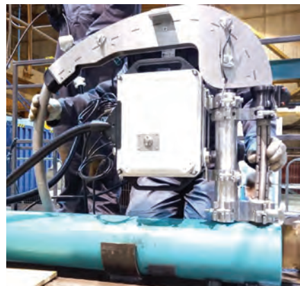
3. HRSG header and full-tube inspection tool, Altrad Babcock
